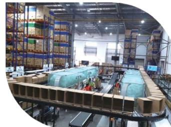
荣庆物流太仓自动化仓库上线全新自动化分拣系统，该系统具备模块化设计和较强的灵活性，帮助客户准确快速地处理多渠道订单
